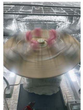
図1 谷澤さんが自作した遠心機
